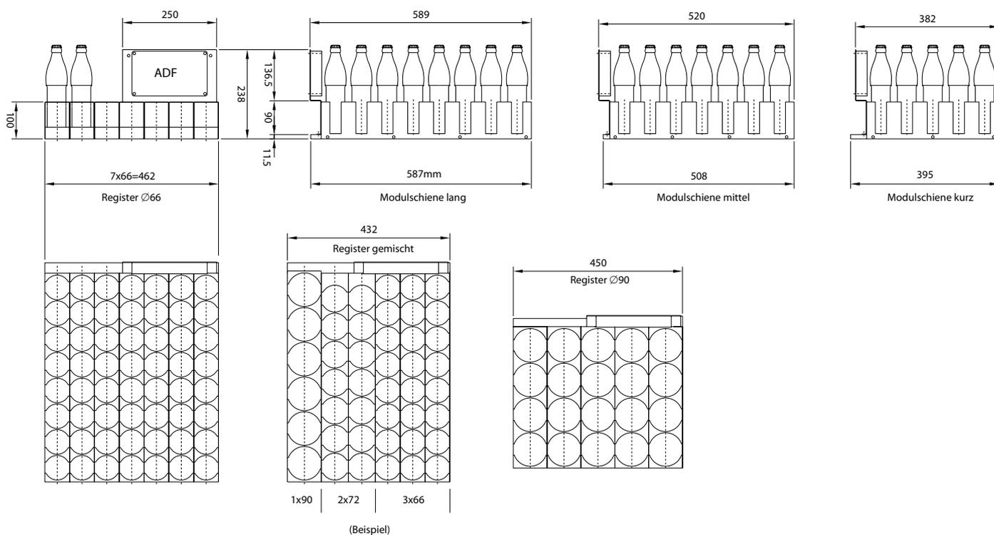
Die Kontrollregister können in drei Längen mit Modulschienen in drei Breiten (= Flaschen-Ø) individuell zusammengestellt werden. Massgebend für die Grösse ist der Innenraum der Kühlschubläden. Pro Auslese-Elektronik ADF können max. 8 Produkte zu je 8 Einheiten verwaltet werden.
